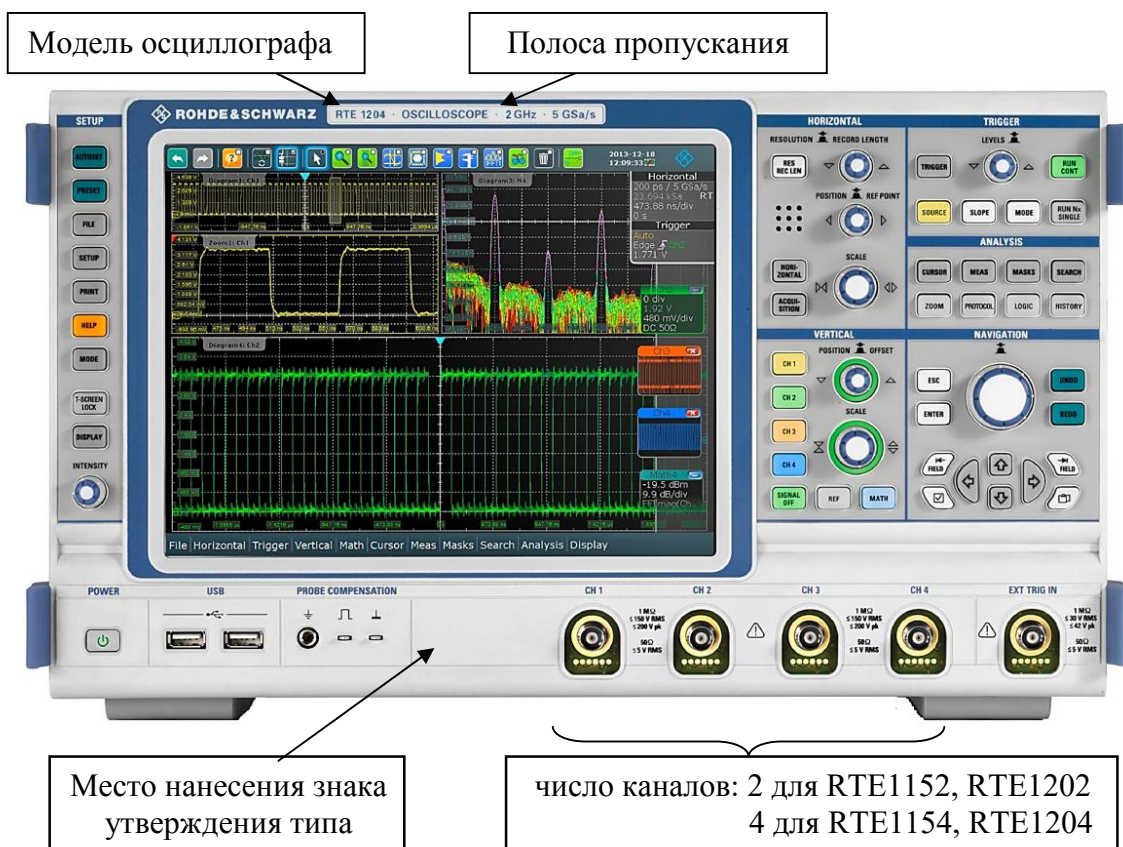
Рисунок 1 - Общий вид средства измерений
