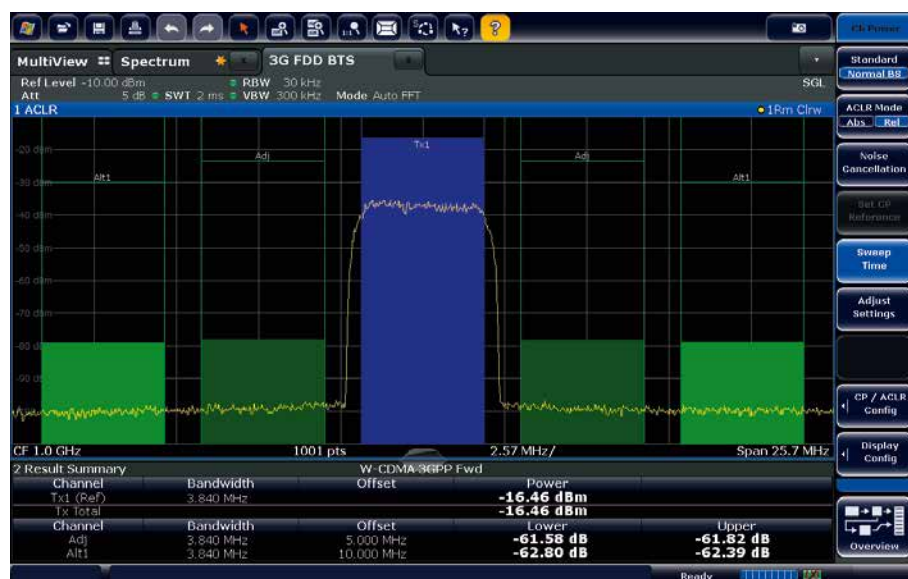
Измерения коэффициента утечки в соседний канал (ACLR) сигнала 3GPP WCDMA
