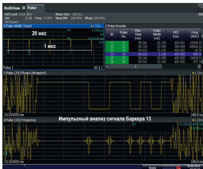
Рис. 3 – С помощью опции импульсных измерений R&S®FSW-K6 широкополосный импульс может быть выделен и полностью проанализирован.
