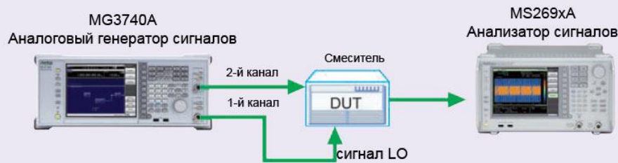
Схема для оценки характеристик искажения смесителя
