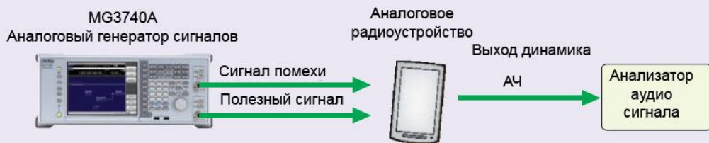
Схема подключения для измерения характеристик аналогового радиоприемника
