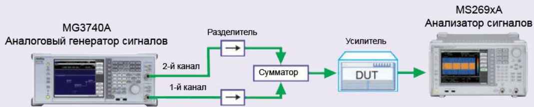
Схема подключения для оценки интермодуляционных характеристик усилителя
