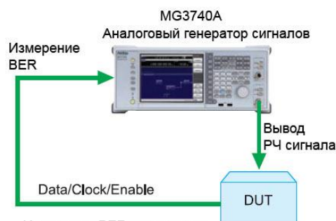
Измерение BER с помощью сигналов Data/Clock/Enable, демодулированных на тестируемом устройстве
