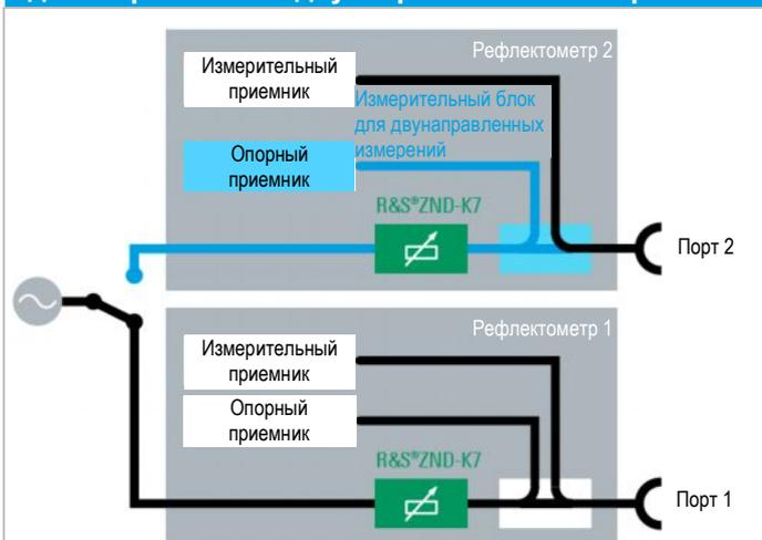
Измерительный блок для проведения однонаправленных измерений (черный) прибора R&S®ZND, расширение для проведения двунаправленных измерений (синий) и опции расширенного диапазона мощности (зеленый).
