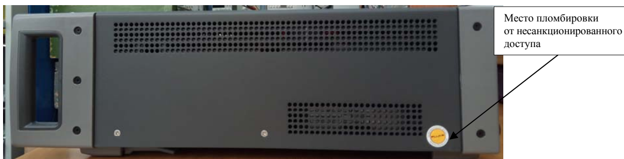
Рисунок 2 - Схема пломбировки от несанкционированного доступа
