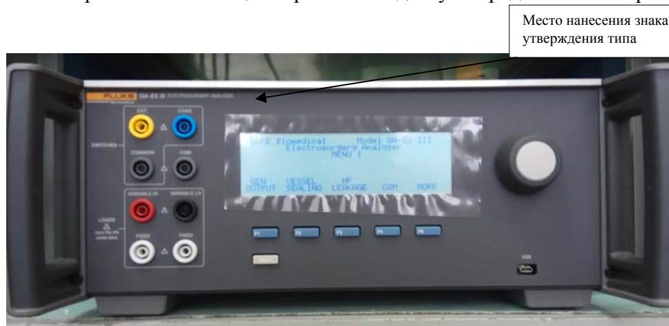
Рисунок 1 - Общий вид анализатора электрохирургических устройств QA-ES III
