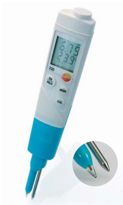
pH2 наконечник зонда для полутвердых субстанций
