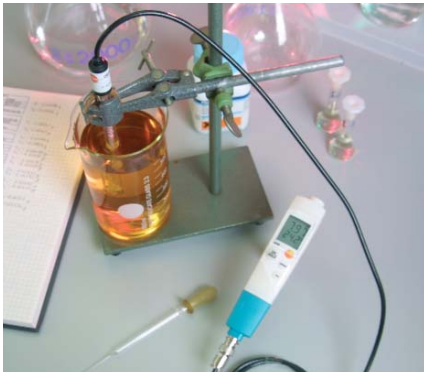
testo 206-pH3 обеспечивает подсоединение внешних зондов
