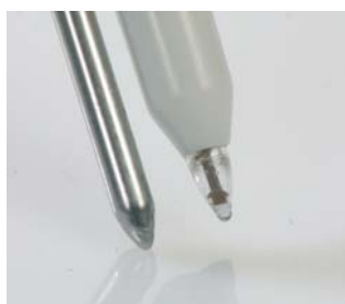
pH наконечник, вставленный в прочный пластик
