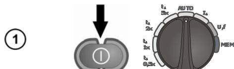
Включите измеритель. Установите поворотный переключатель в режим AUTO.
