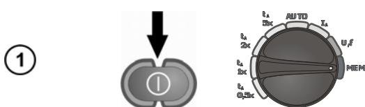
Включите измеритель. Установите поворотный переключатель в положение **MEM**.
