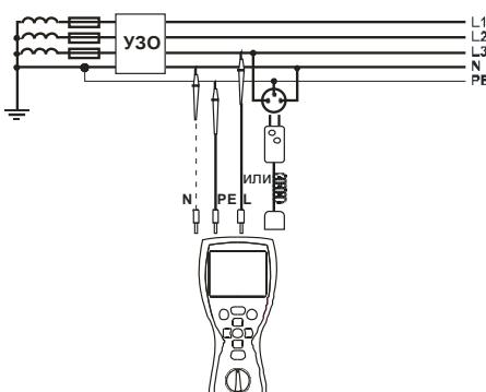
Подключите измеритель согласно схеме
