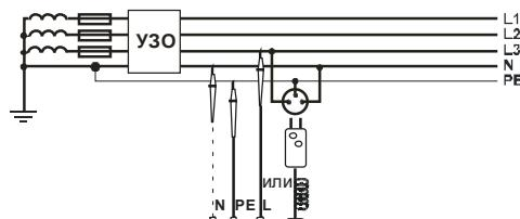
Подключите измеритель согласно схеме
