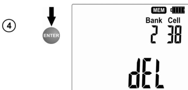
После подтверждения удаления, на дисплее отобразится быстрая смена номеров ячеек памяти, а по окончанию, отобразится первая ячейка и прозвучит звуковой сигнал.
