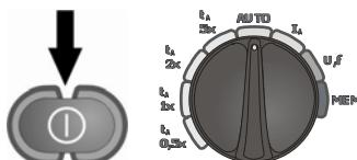
Включите измеритель. Установите поворотный переключатель в режим **AUTO**.
