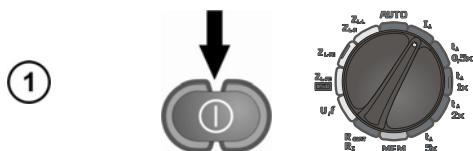
Включите измеритель. Установите поворотный переключатель в режим  $I_A$ .
