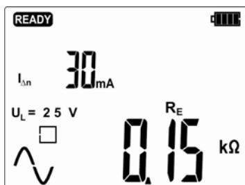
Сопротивление защитного заземления  $R_E$
