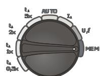
Включите измеритель. Установите поворотный переключатель в положение **MEM**.
