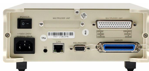
Задняя панель АКИП-6303-12 (12 кан вариант)
