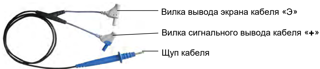
Рисунок 1.5.2 Внешний вид кабеля
