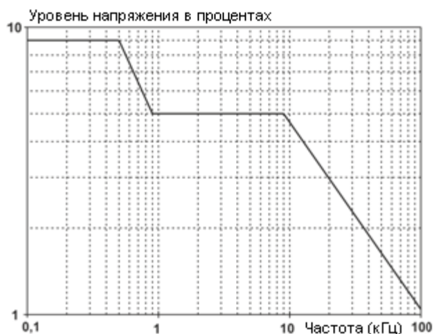
Рис.49. Допустимые уровни управляющих сигналов.
